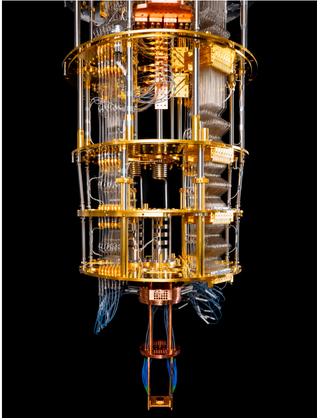
Abbildung 1 – Kryostat zum Betrieb von supraleitenden Quantenprozessoren bei tiefen Temperaturen. © Mikka Stampa/MQV.
